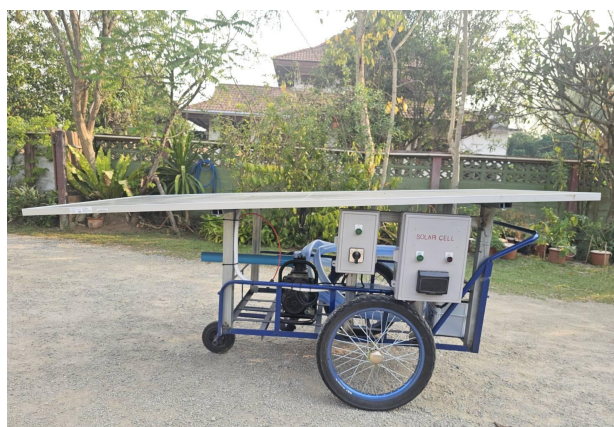
ภาพที่ 4.9 ระบบสูบน้ำพลังงานแสงอาทิตย์แบบเคลื่อน
